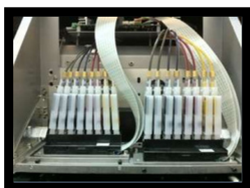
Cabezales Epson DX5 Gota Variable Resolución 1440 dpi
